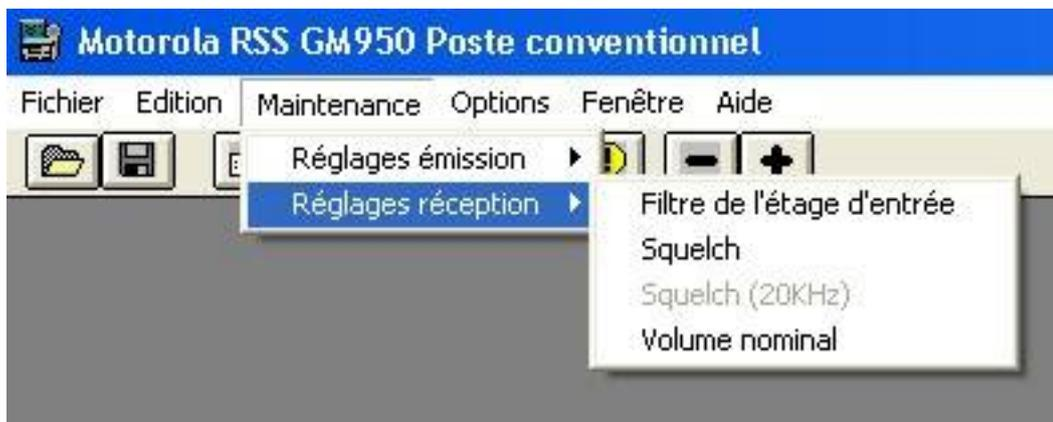
Les caractéristiques du récepteur du poste sont réglées dans les écrans de réglage du récepteur.
