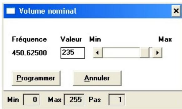
La valeur du potentiomètre du volume nominal règle le volume maximal sur une modulation de contrôle normale.
