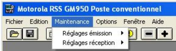
Cette section du logiciel RSS sert à régler le poste. Elle présente deux fenêtres principales, à savoir les Réglages d'émission et les Réglages de réception. Ces deux fenêtres contiennent plusieurs écrans nécessaires au réglage et à la configuration du récepteur et de l'émetteur.
